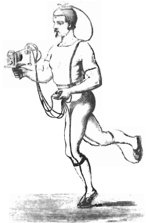
Abb. 2. Etienne-Jules Marey, Läufer mit »Experimentalschuhen« und Aufzeichnungsapparat (aus: Marey, La Machine animale , Paris 1873)
